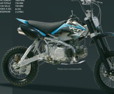
ENGINE TYPE 125CC SINGLE CYLINDER AIR COOLED 4 STROKE COMPRESSION LUBRIFICATION CARBURATION RATIO 9:3:1 SANS PLOMB 95 22 CDI
